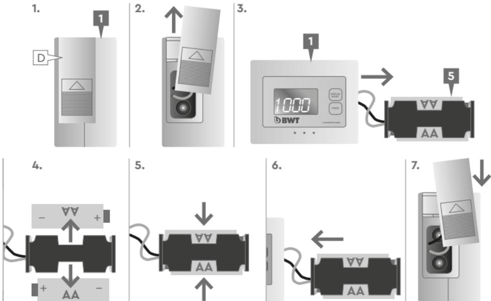
**b** **DE** Zähleinheit montieren **EN** Install counting unit **FR** Installation compteur
